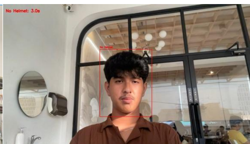
Gambar 7. Tampilan Tidak Menggunakan Safety Helemet
