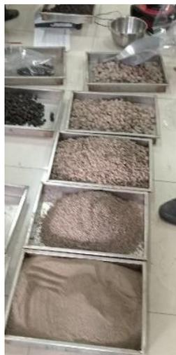
**Gambar 3. Hasil analisis saringan untuk agregat eksisting**
