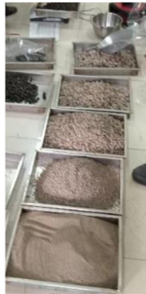
Gambar 3. Hasil analisis saringan untuk agregat eksisting
